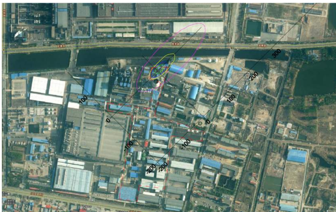
(注：紫色代表 20 年污染晕、黄色代表 1000d 污染晕、蓝色代表 365d 污染晕，绿色代表 100d 污染晕，红色为厂界线) (局部放大图)
